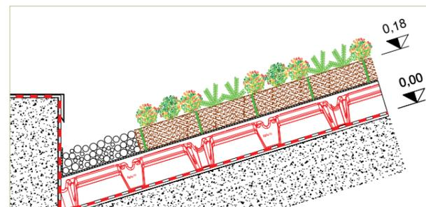
Detalhes de construção de jardins suspensos extensivos em telhado inclinado.
