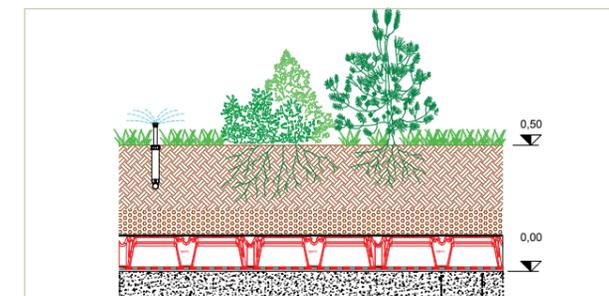
Detalhes de construção de jardins suspensos intensivos pesados.
